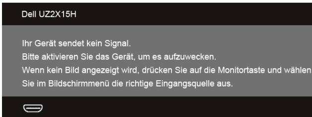
Wenn der VGA, HDMI (MHL) oder DP-Eingang ausgewählt ist, aber das entsprechende Kabel nicht angeschlossen ist, wird das nachstehend gezeigte Dialogfeld eingeblendet.
