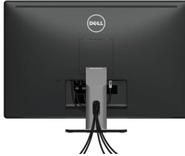
Nachdem Sie sämtliche erforderlichen Kabelverbindungen an Monitor und Computer hergestellt haben (siehe [Monitor anschließen](#)), führen Sie die Kabel wie oben gezeigt ordentlich durch den Kabelschacht.
